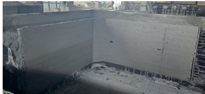
Figura 2 - Peça com 2% de DRYDuraCon® sobre a massa de cimento.
