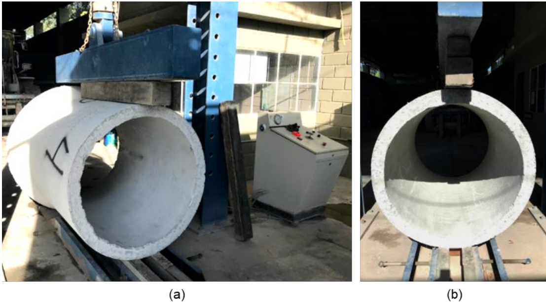
Figura 4 - Ensaio de compressão diametral: (a) tubo posicionado na máquina de ensaio (a); (b) destaque para o apoio de três cutelos.
