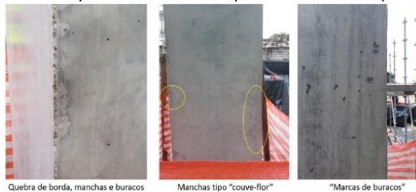
Figura 11: Amostras de concreto arquitetônico com 3 tipos de cimento - (Fonte: Arquivo S. Takashima)
