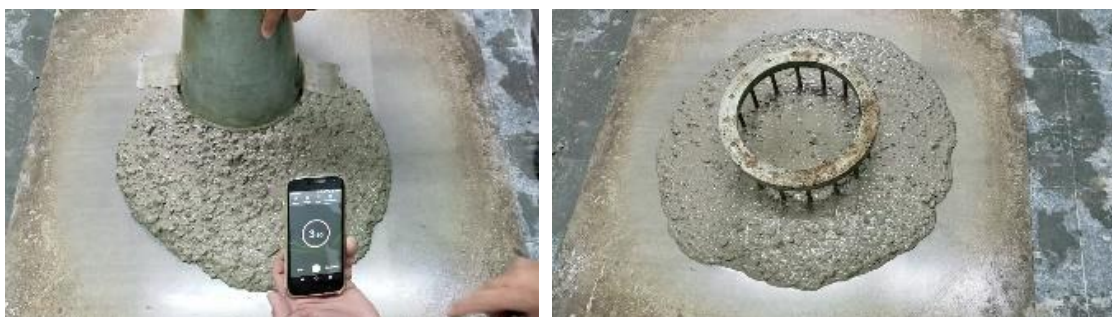
Figura 5: Ensaios do concreto autoadensável em estudos de dosagens realizados para as concretagens do Complexo Fasano (Fonte: Arquivo S. Takashima)
