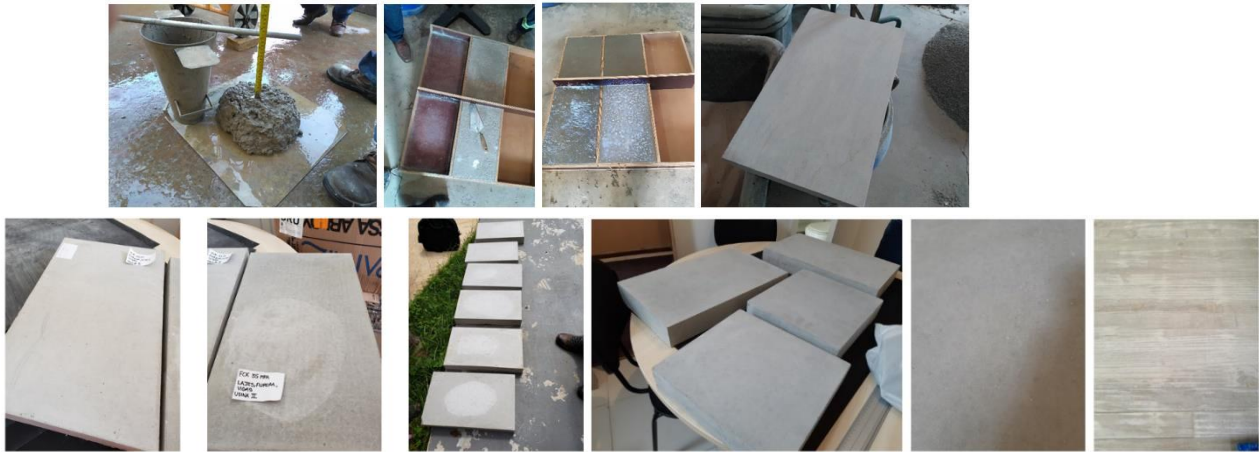
Figura 10: Amostras de concreto arquitetônico com 3 tipos de cimento - (Fonte: Arquivo S. Takashima)
