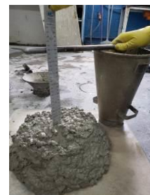
Figura 4: Slump S160 (Fonte: Arquivo S. Takashima)
