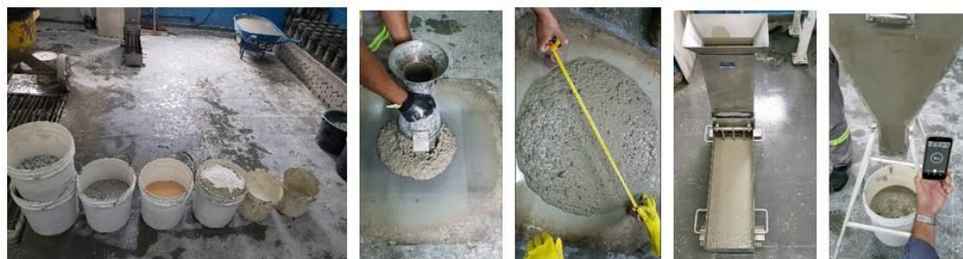
Figuras 3: Ensaios do concreto autoadensável em estudos de dosagens realizados para as concretagens do Complexo Fasano (Fonte: Arquivo S. Takashima)
