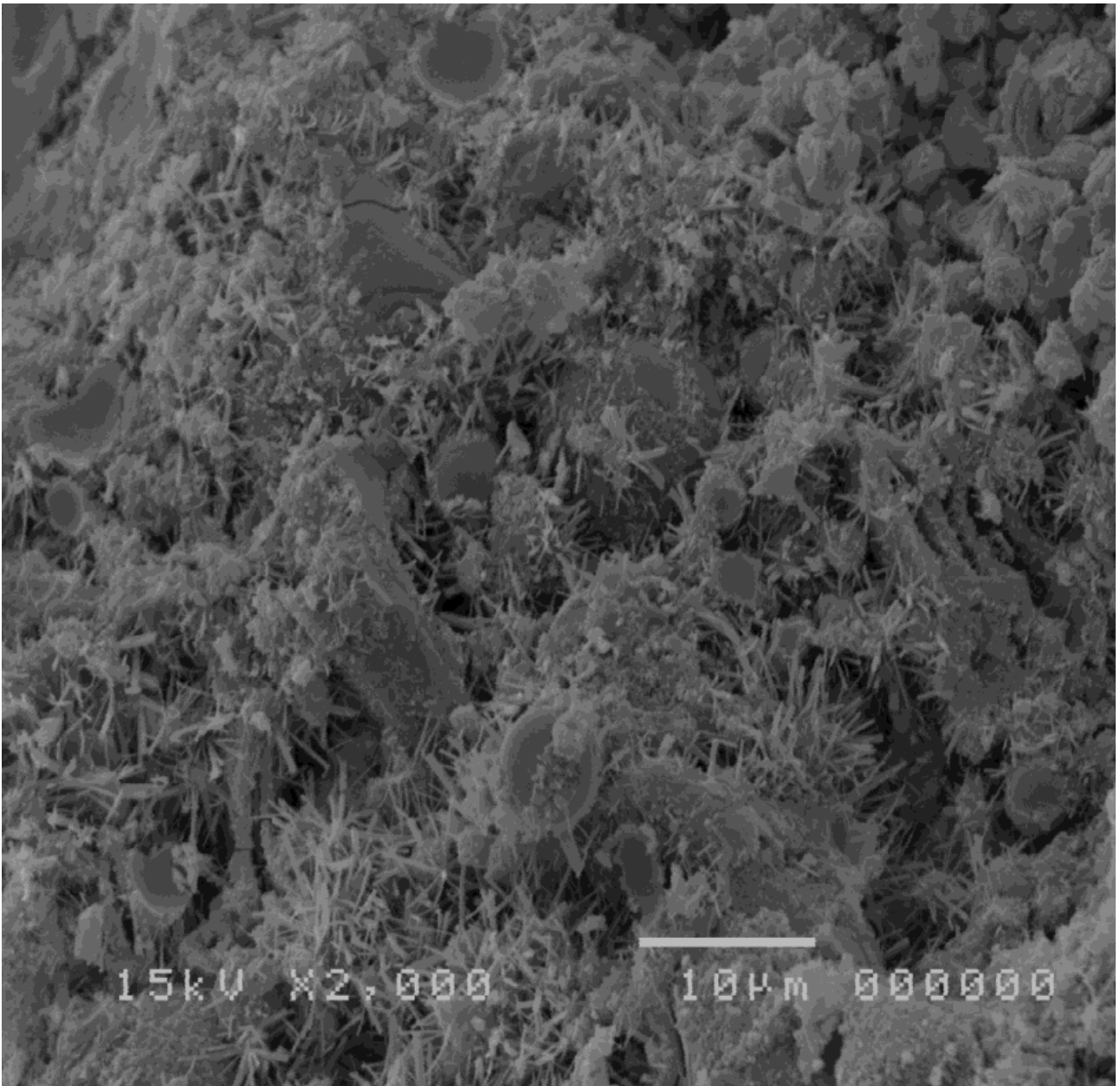
Figura 3/E-SEM Micrografia-muito compacto matriz de cimento pozolânico-Pozzolanic.
