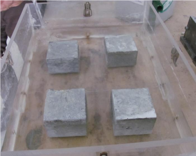
Foto – Teste de absorção de água
