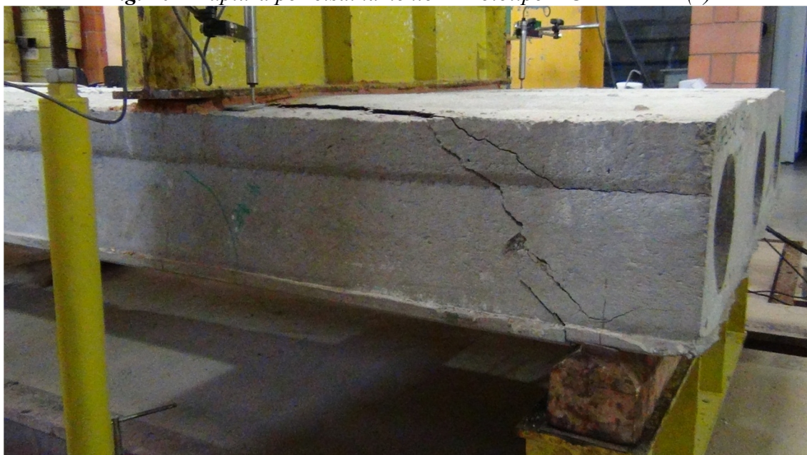
Fig. 10 – Ruptura por cisalhamento – Protótipo 1 CAA + BAR (1)
