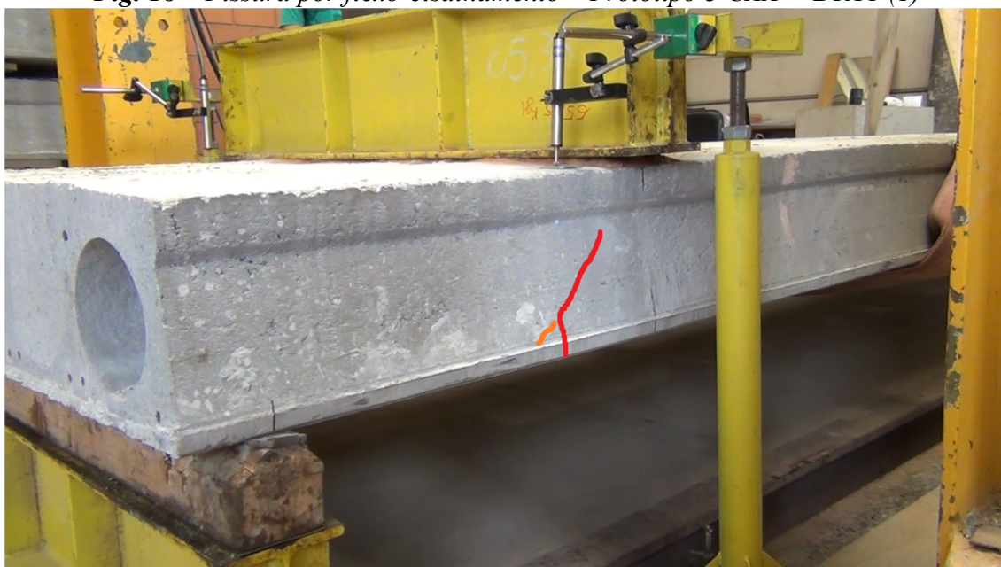
Fig. 18 – Fissura por flexo-cisalhamento – Protótipo 3 CAA + DRYI (1)
