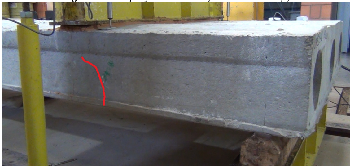
Fig. 9 – Fissura por flexão – Protótipo 1 CAA + BAR (1)
