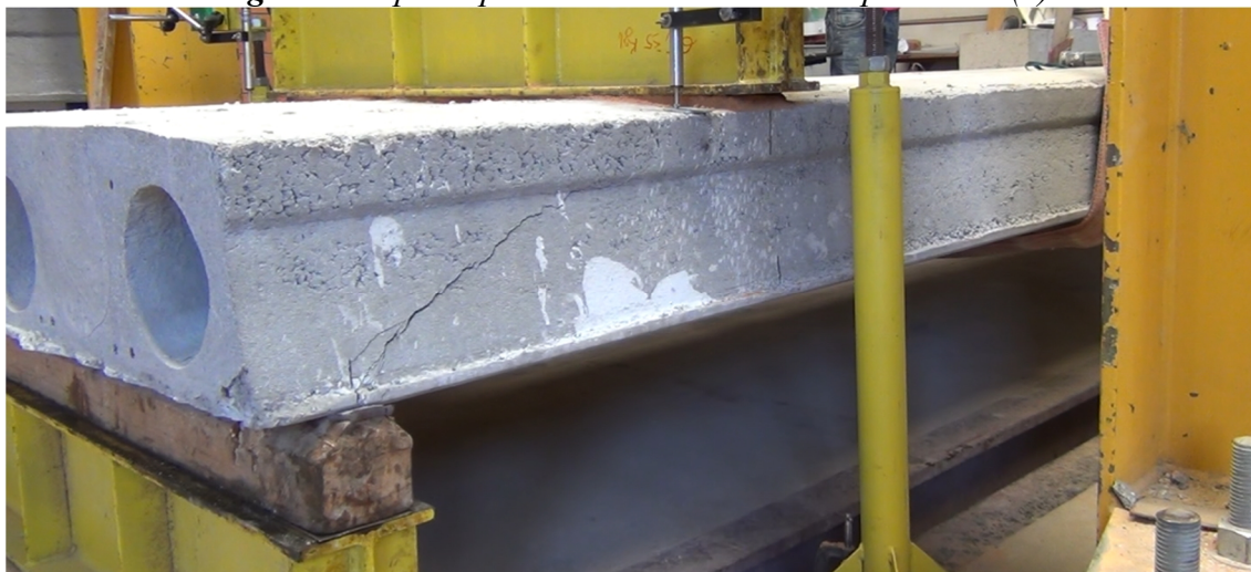
Fig. 13 – Ruptura por cisalhamento – Protótipo 2 CAA (1)
