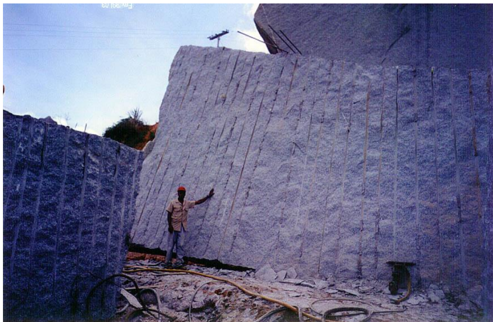
Superfície cortada com argamassa expansiva Fract.Ag na lavra de matacão do granito Cinza Corumbá.
