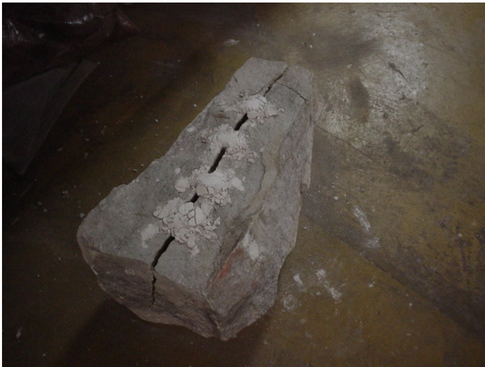
Figura 2.1 – Bloco de rocha onde foi feita a furação para a aplicação da argamassa expansiva em escala piloto.
