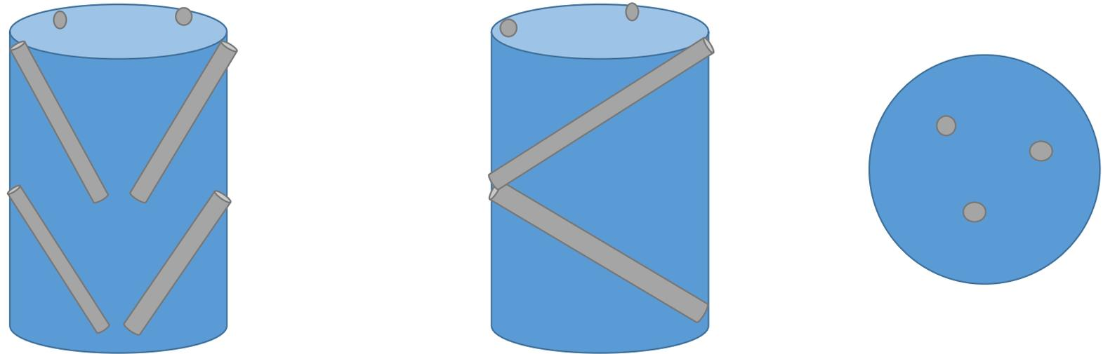
Furos de diâmetro entre 34 e 40 mm.
