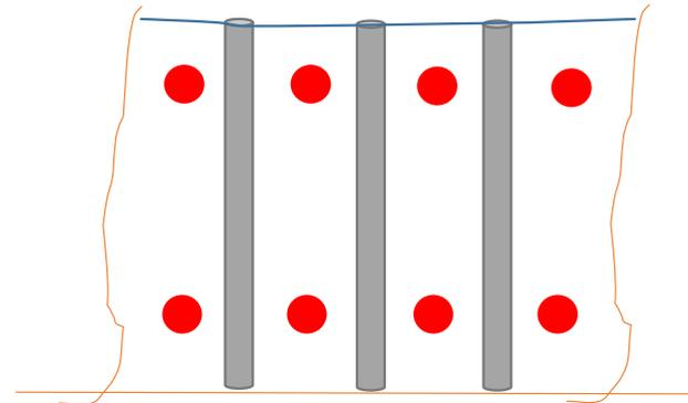
Furos de diâmetro entre 34 e 40 mm.
