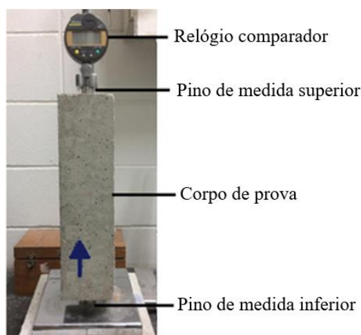
Figura 5 - Aparato para determinação da variação dimensional. A seta azul indica a posição do corpo de prova durante o ensaio.
